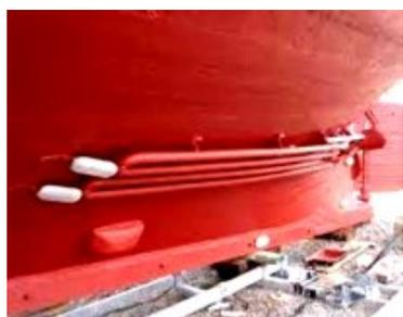
limiter et maîtriser ce risque que les navires opérant habituellement dans ce type d'endroit n'ont pas, la plupart du temps, été conçu avec le système "**keel cooling**", le refroidissement des moteurs ne se faisant pas par aspiration/circulation d'eau extérieure, mais par un circuit fermé le long de la coque, refroidi au contact de l'eau extérieure.
