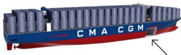
Emplacement des futurs réservoirs de GNL à l'avant
