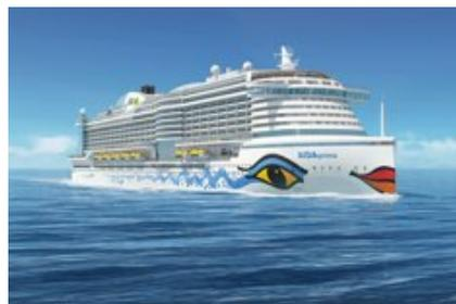
Le "AidaPrima". Longueur : 300 m. Largeur 37,60 m. 125.000 t. dispose d'un système d'injection d'air sous la coque en vue de réduire la résistance à l'avancement durant la navigation.
